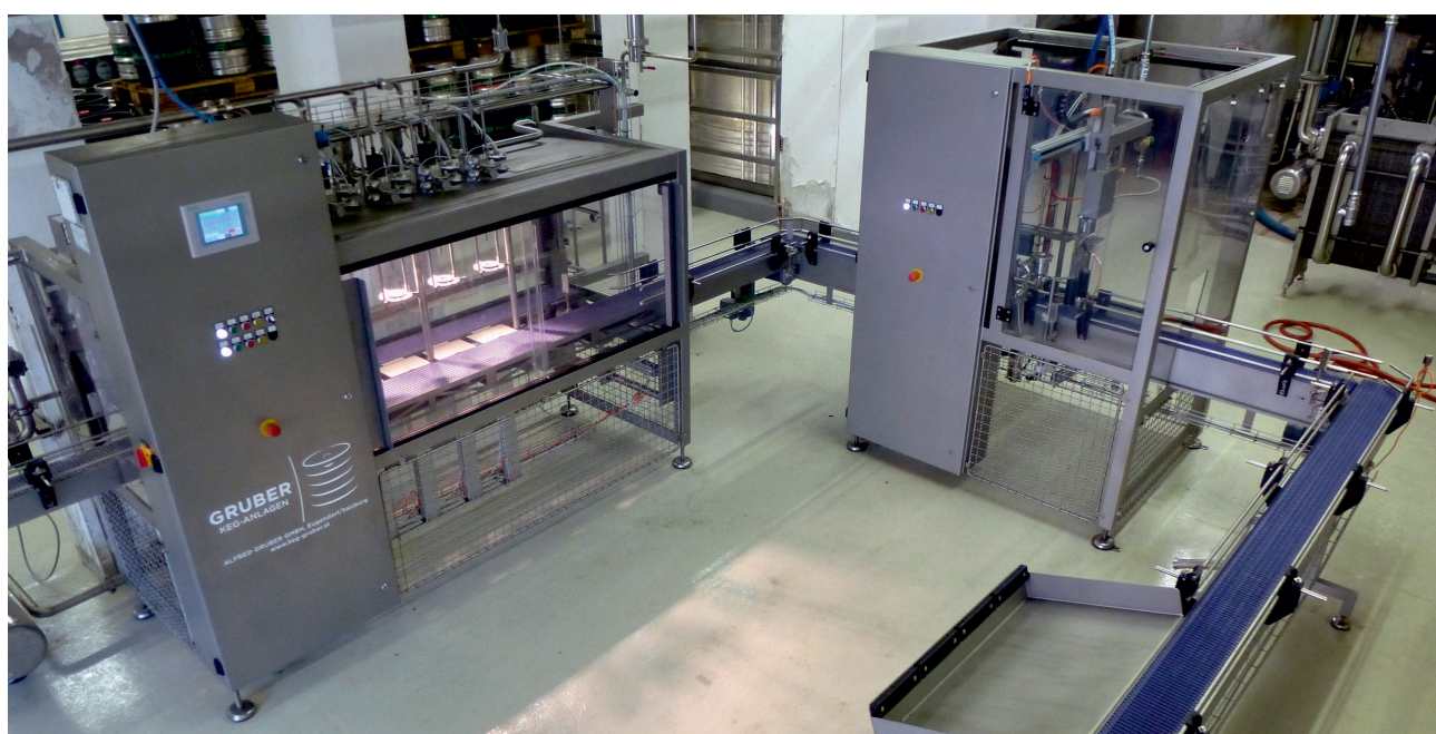
AFD 6 mit automatischen 5l Dosenverschleißer AFD 6 with a fully automatic 5l partykeg capper
