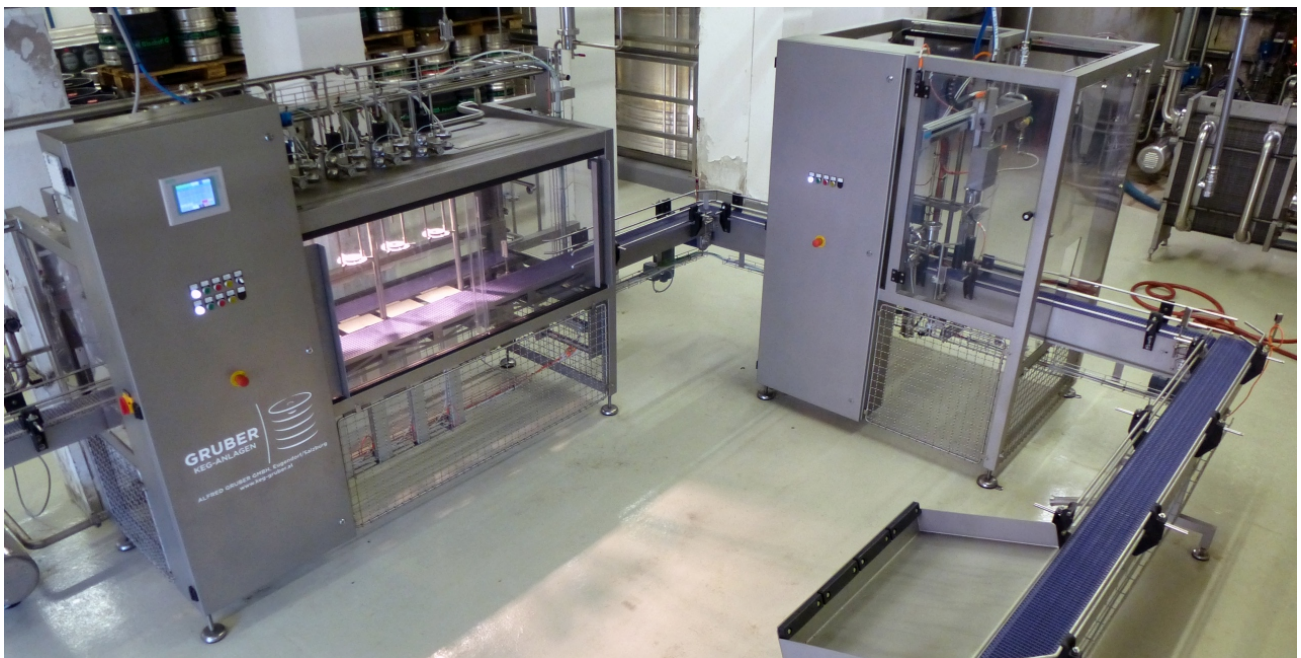
AFD 4 mit automatischem 5l Dosenverschleißer AFD 4 with a fully automatic 5l partykeg capper
