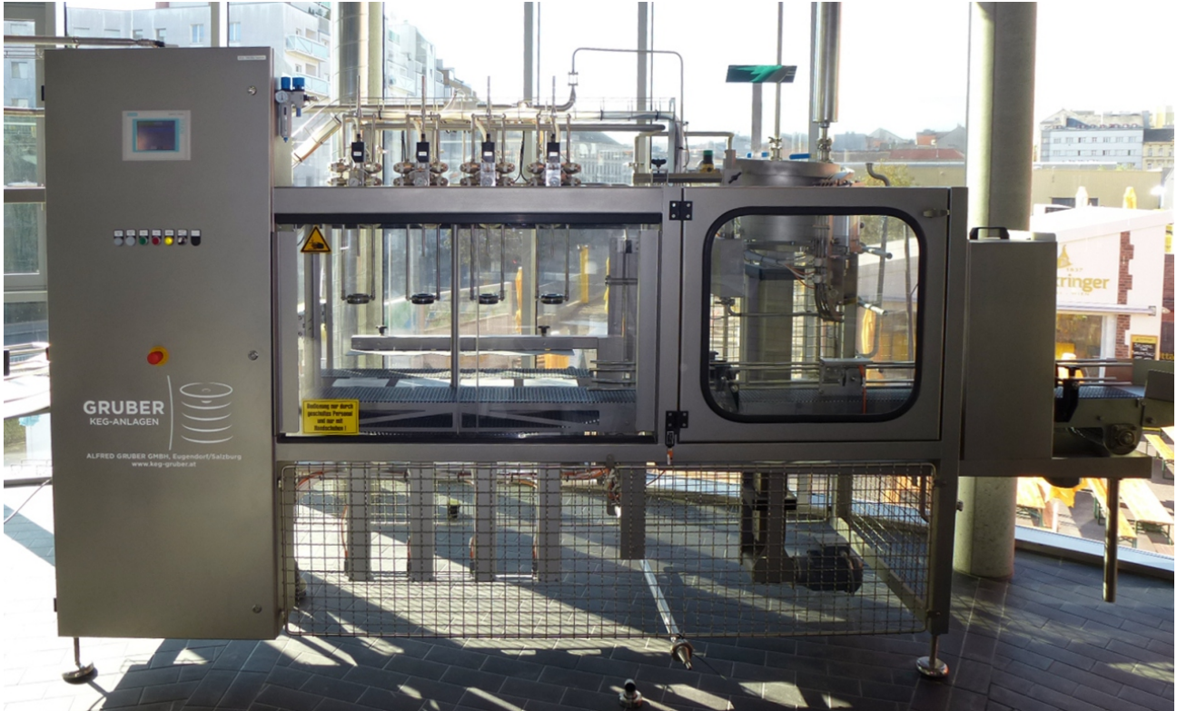
AFD 4 mit automatischem Kronenkorker für \varnothing 26\text{mm} und \varnothing 29\text{mm} AFD 4 with fully automatic bottle capper for \varnothing 26\text{mm} und \varnothing 29\text{mm} crowns
