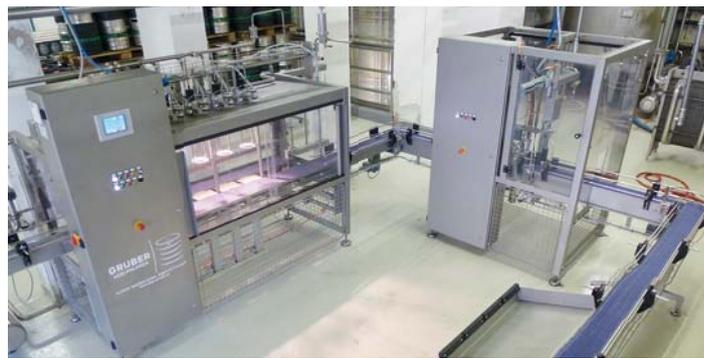
5l-Dosenabfüllung für maximal 240 Dosen pro Stunde
