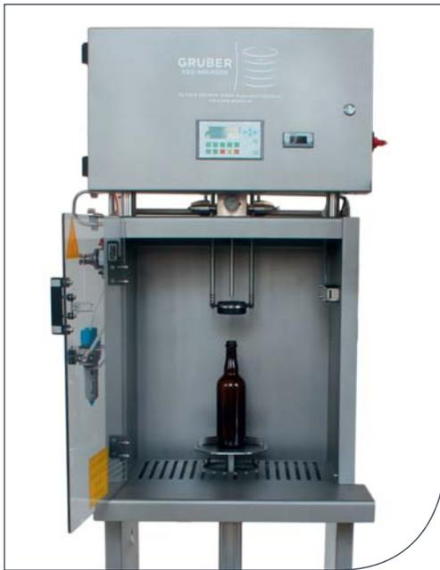
*Flaschenfüller, halb- bis vollautomatisch, 20 - 800 Fl./h*
